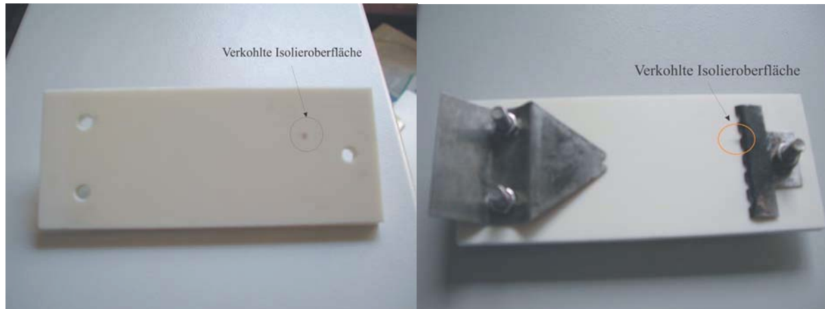
Bild 9.2: Entladungskanäle auf der Prüflingsoberfläche (Füllstoff Typ K)
