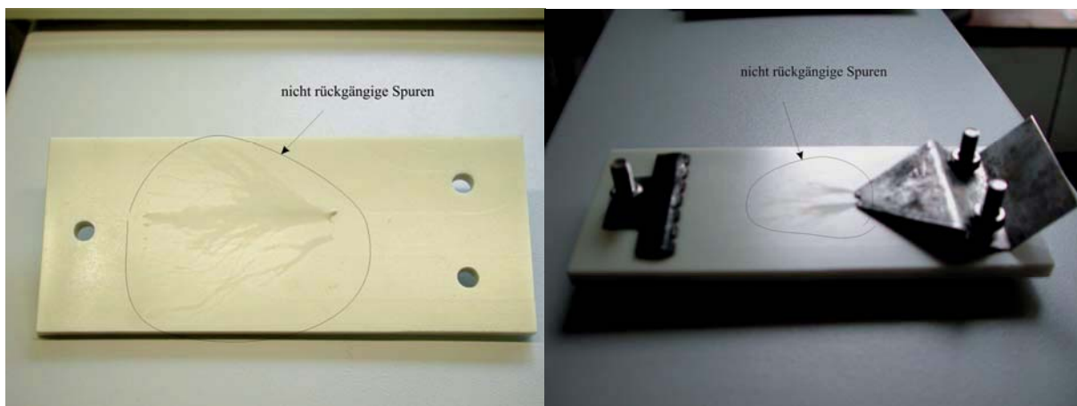
Bild 9.1: Entladungskanäle auf der Prüflingsoberfläche (Füllstoff Typ M )
