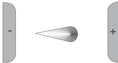
Bild 4.1: Verteilung der Ladungsträger bei einem Streamerdurchschlag
