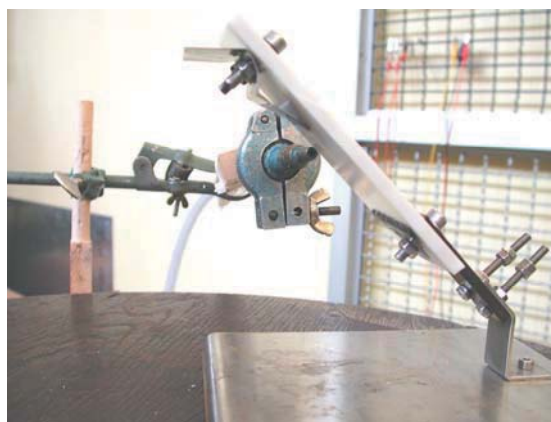
Bild 7.11: Prüfling-Düse-Anordnung für einen Versuch unter Luftströmungseinfluss
