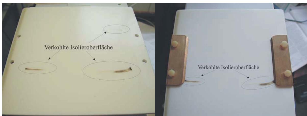
Bild 9.3: Entladungskanäle auf der Prüflingsoberfläche mit dem Füllstoff Typ K
