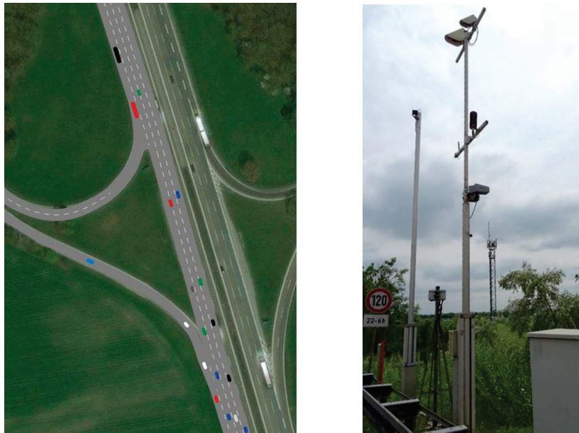
Abbildung 7: links: Ausschnitt eines Modells eines Streckennetzes in PTV Vissim, rechts: Messanlage zur Erfassung von Verkehrsdaten
