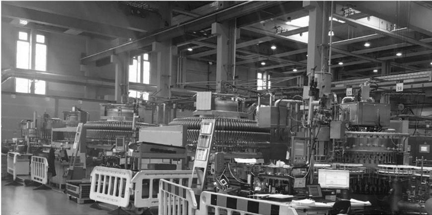
**Abbildung 1:** Werkshalle 5 Endmontage von Abfüllmaschinen mit aktuell zu montierenden Anlagen aus der Fülltechnik
