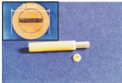
Abbildung 6.5: In  $\text{Al}_2\text{O}_3$ -Röhrchen eingebettete TEM-Probe. Die Ausschnittsvergrößerung zeigt die Draufsicht auf das Querschnittspräparat.
