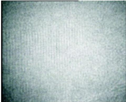
Abbildung 7.2: Originalbild eines  $\text{Cu}_3\text{Au}$ -Nanopartikels, aufgenommen am JEM ARM 1250 bei  $T = T_0 - 9 \text{ K}$  bei einer 16 Mio.-fachen Vergrößerung.
