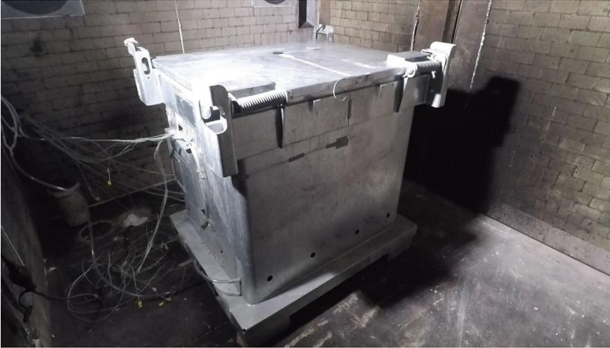
**Abbildung 3.23: Behälter für Havarieversuche mit Möglichkeit zur Gasentnahme**
