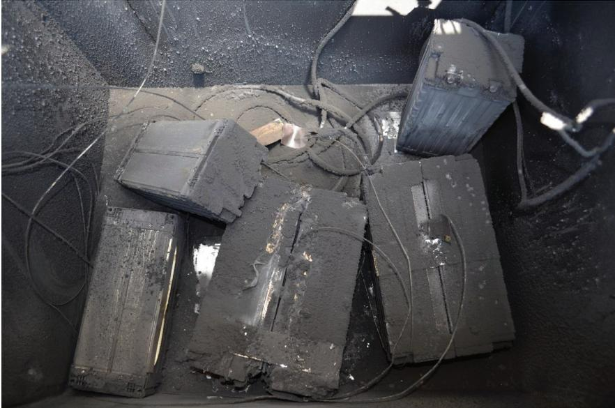
**Abbildung 3.30: Ausgebrannte Batteriemodule nach dem Test im Havariebehälter**
