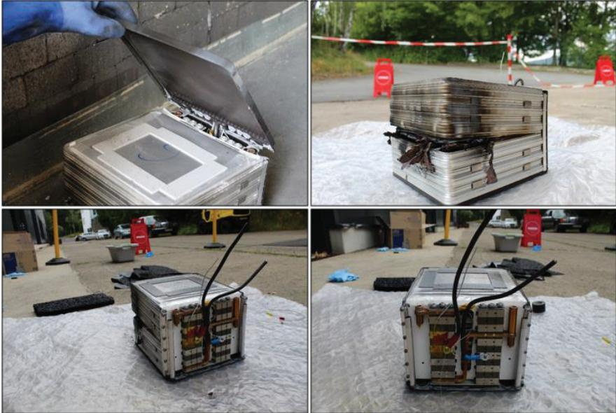
**Abbildung 3.37: Modul mit Brandschutzlagen nach dem Versuch im Brandofen**
