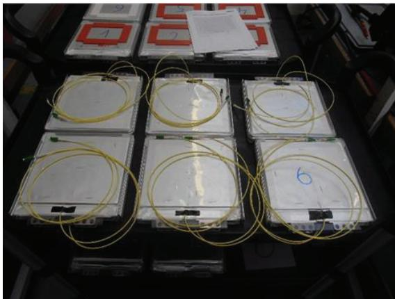
**Abbildung 1.19:** Sechs jeweils aus zwei Einzelzellen bestehende Zellpaare mit applizierter faseroptischer Sensorik.
