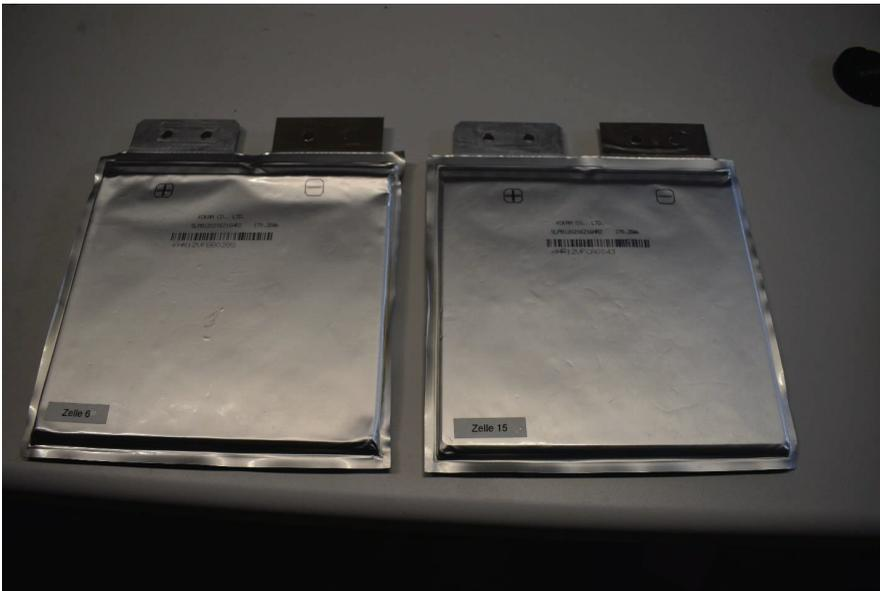
**Abbildung 5.16:** Zellen nach Langzeitversuchen mit Schnellladeverfahren und Veränderungen im oberen Bereich
