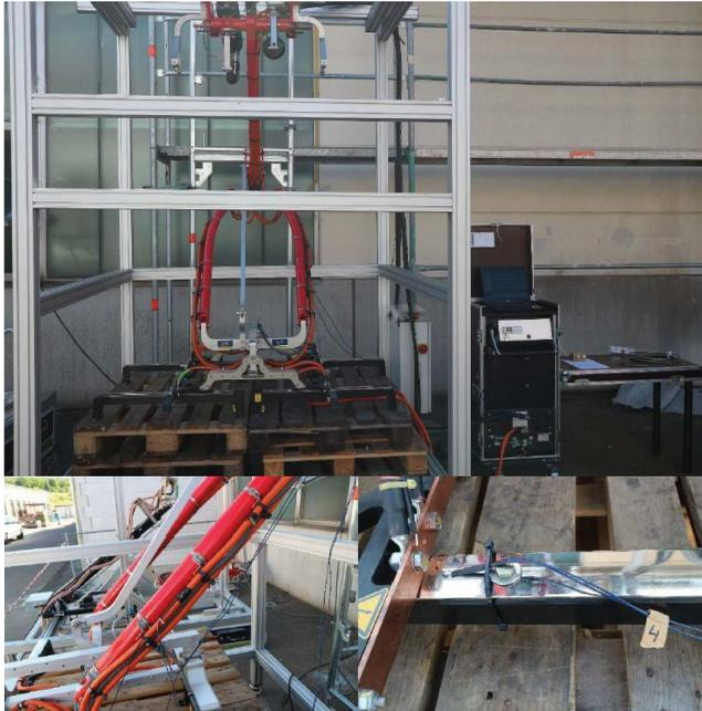
**Abbildung 4.12: Invertierter Ladestromabnehmer SLS 201 im Testfeld**
