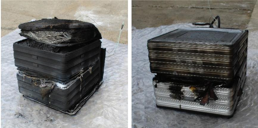
**Abbildung 3.39: Modul ohne Brandschutzlagen (links) nach Abuse-Test mit Initialisierung durch das gezielte Überladen einer Zelle im mittleren Bi-Pack mit Brandschutzlagen (rechts)**
