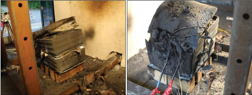
Abbildung 3.35: Modul ohne Brandschutzlagen nach dem Versuch im Brandofen
