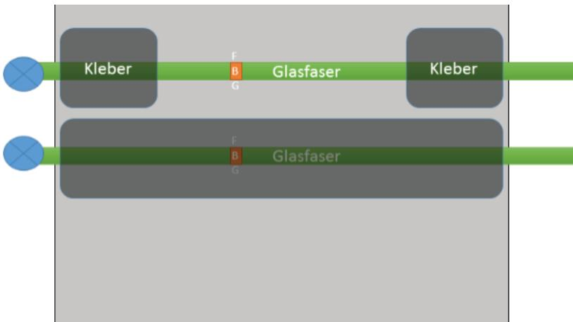
**Abbildung 1.10:** Hüllpolymerfolie einer Lithium-Ionen-Batteriezelle mit aufgeklebten Glasfasersensoren
