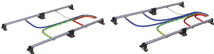
**Abbildung 4.14: Konzept Gegenschchnittstelle invertierter Ladestromabnehmer in 2-poliger und 4-poliger Ausführung**
