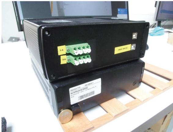
**Abbildung 2.3: Fotografie des optischen Interrogators mit integrierter Superlumineszenzdiode als Lichtquelle**
