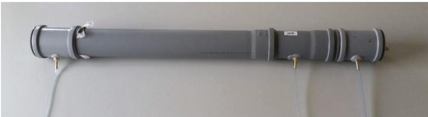
**Abbildung 3.22: Aufbau Strömungswiderstandsmessung**
