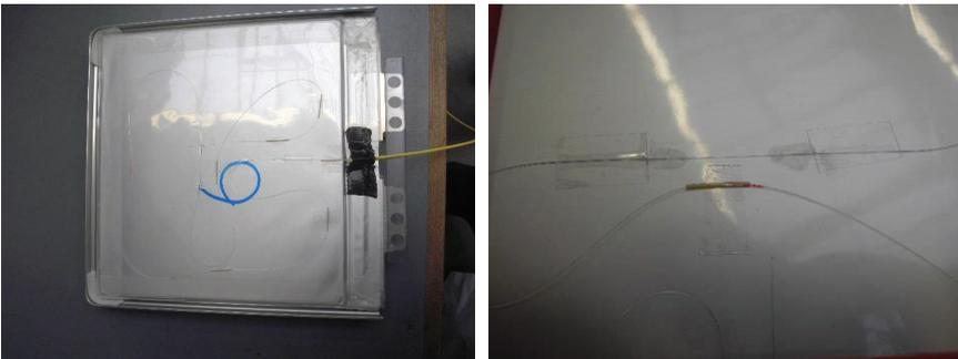
**Abbildung 1.18:** Mit faseroptischen Sensoren in einem Glasfaserstrang ausgestattete Einzelzelle (links) und faseroptische Messstelle mit der oberen Dehnungskomponente und der unteren signalkompensierender Temperaturkomponente (rechts)
