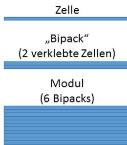
**Abbildung 1.16: Prinzipieller Modulaufbau**
