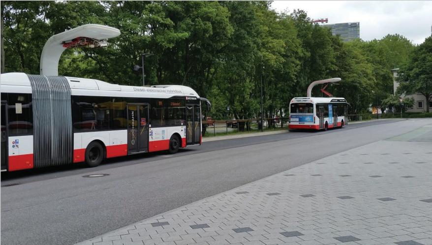
**Abbildung 5.54: Konduktives Laden mittels Pantographen in Hamburg**
