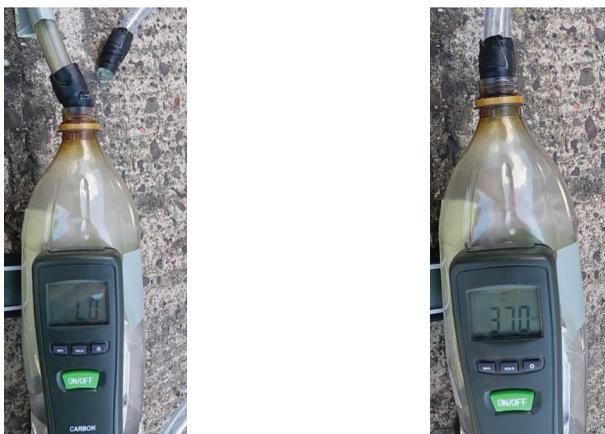
Abbildung 3.24: Ergebnisse aus Vorversuchen zur Messung von Kohlenmonoxid vor dem Filter (links) und nach dem Filter (rechts)
