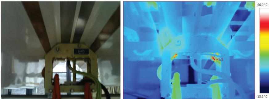
**Abbildung 4.20: Kontaktkopf (links) und Wärmebild des Kontaktkopfes nach 300 s Belastung mit 600 A (rechts)**
