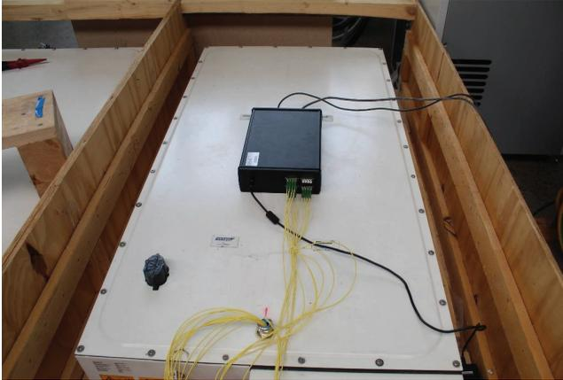
Abbildung 2.21: Aufbau der durchgeführten Zyklierversuche mit Batterie (weiß), faseroptischer Sensorik (gelb) sowie dem Spektrometer (schwarz)
