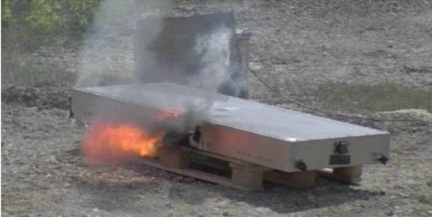
**Abbildung 3.42: Versuche mit Brandschutzlagen im System**
