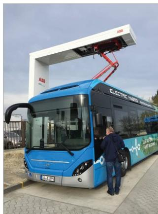
**Abbildung 5.47: Konduktives Laden per Pantograph auf dem Betriebshof der Göttinger Verkehrsbetriebe GmbH**
