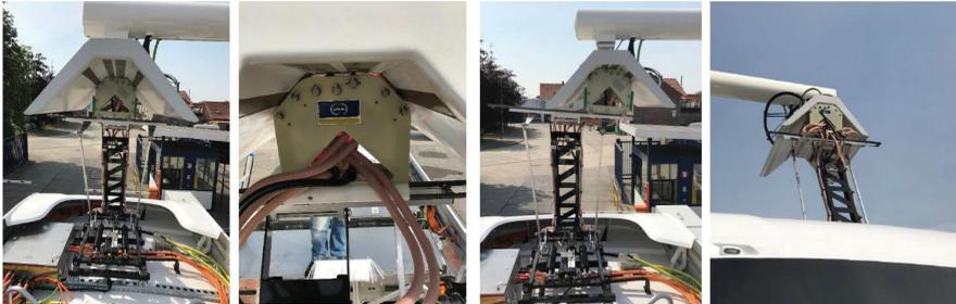
**Abbildung 4.18:** Versuche zur Kontaktierung (Kontaktkopf und Haube) in einer Feldversuchsumgebung
