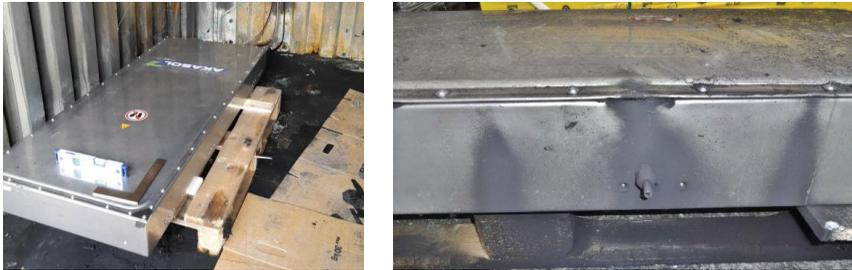
**Abbildung 3.45: System zur Prüfung in der Abuse-Kammer (links) und nach dem Versuch (rechts)**
