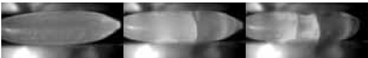
Abb. 4.18: Optische Aufnahmen eines uniaxialen Druckversuches mit Reis (unbehandelt).
