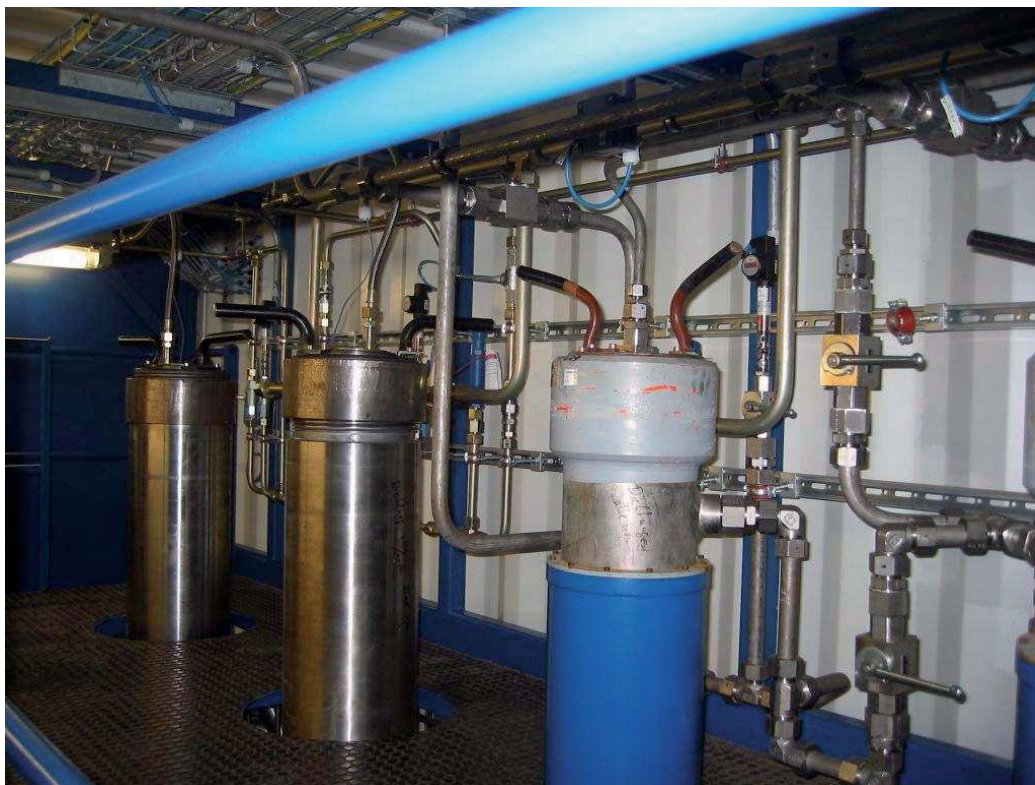
Abb. II.XIII.04: Extraktionsbehälter zur Emulsionsspaltung
