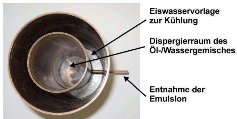
Abb. 5.17: Kupferanrührbehälter mit Kühlmöglichkeit und Entnahmestutzen
