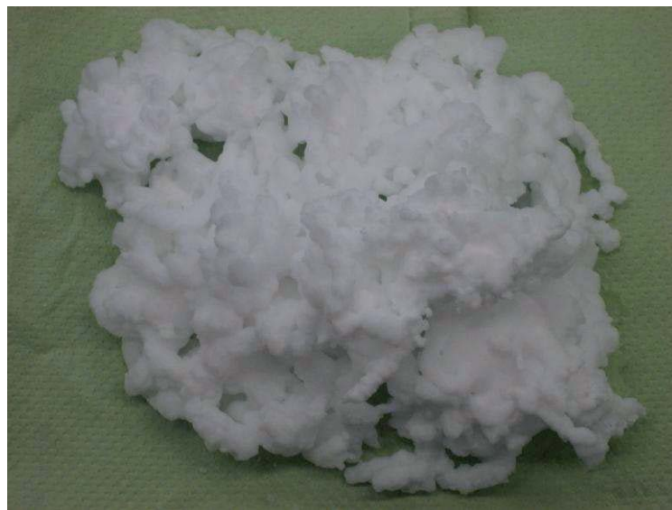
Abb. 7.14: Voluminös schaumartige Probeentnahme der 80^{\circ}\text{C} - und 120^{\circ}\text{C} - Isothermen des Pseudo-Binärstoffsystems Plantacare 1200 UP ® / Propan, expandiert von 100 bar gegen Atmosphärendruck
