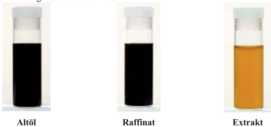
Abb. 3.07: Aufnahmen des Eduktes Altöl sowie der Extraktionsprodukte Extrakt und Raffinat
