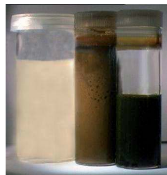
Abb. 6.04: Propangehalt der koexistierenden wasser- bzw. ölreichen Phasen des pseudo-ternären Systems (Wasser, Öl, Tenside, Feststoffe, Propan) in Gegenwart verdichteten Propanns bei unterschiedlichen Temperaturen und Drücken
