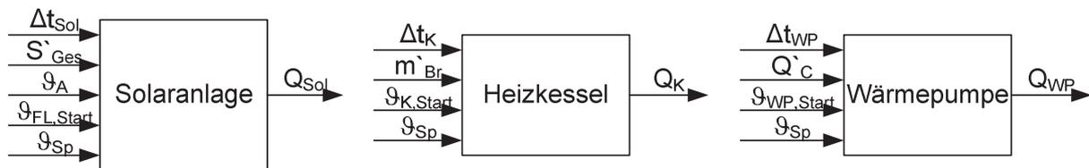
**Abbildung 3-14: Prozesskennfelder der Wärmeerzeuger**
