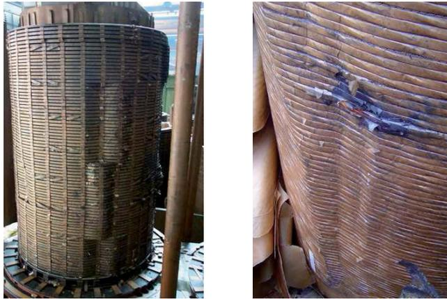
Abb. 4.13: Radiale Deformationen an Transformatorwicklungen
