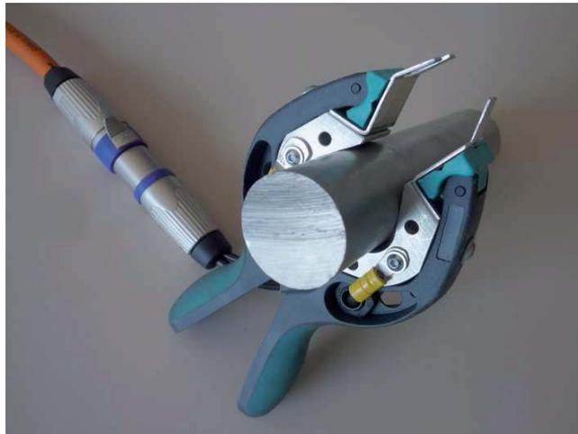
Abb. 8.6: Anschlussklemme am Modell eines Durchführungsbolzens
