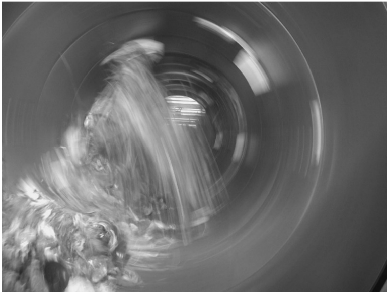
Figura 4 – As peneiras em tambor não atendem ao efeito de separação pretendido
