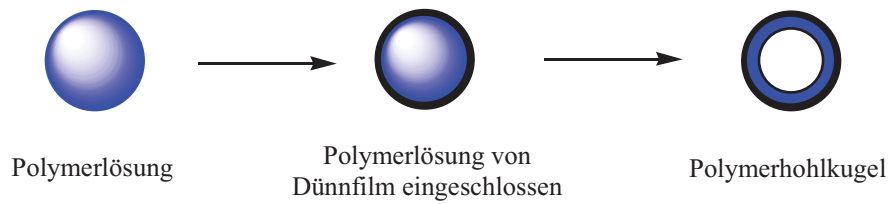
Abbildung 10: Schema der Flüssigtropfenmethode zur Darstellung hohler Polymerpartikel
