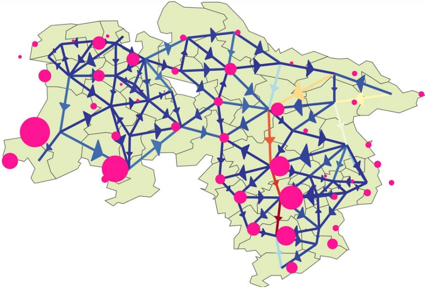
Abbildung 20: Auf Basis der in Niedersachsen verfügbaren EE-Potenziale produzierbarer Wasserstoff im Kontext des deutschen Gesamtenergiesystems Je größer die rosa Kreise, desto größer die zu produzierende Menge Wasserstoff. Die Pfeile beschreiben die Transportwege zwischen den einzelnen Knotenpunkten (Landkreise)
