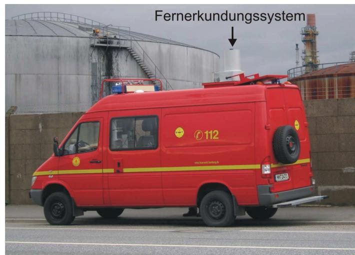
Abbildung 56: Fernerkundungssystem SIGIS 2 in einem eigens dafür ausgerüsteten Messfahrzeug der Berufsfeuerwehr Hamburg.
