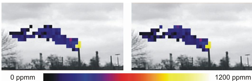
Abbildung 67: Falschfarbdarstellung von gemessenen und rekonstruierten Säulendichten der Position 2 zugehörigen Projektion. Links: Gemessene Projektion. Rechts: Rekonstruktion.
