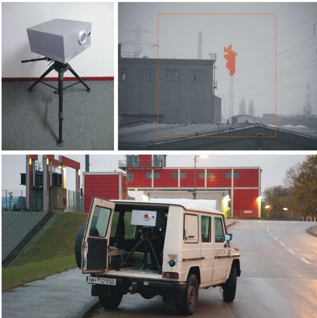
Abbildung 80: Infrarot-Gefahrstoffkamera. Oben links: Neues Fernerkundungssystem mit Arraydetektor. Oben rechts: Messung einer Ammoniakwolke. Unten: Gefahrstoffkamera im Messfahrzeug.
