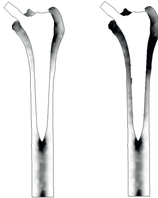
Abb. 2. Simulierte Veränderung der Knochenstruktur im Oberschenkelknochen zufolge einer Hüftgelenks-Endoprothese, links postoperativ, rechts Langzeitreaktion.
