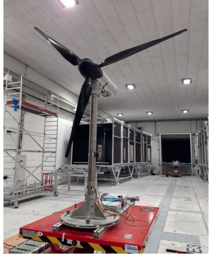
Abb. 4: links: Versuchskörper der Jacket-Tragstruktur einer 20+ MW-Offshore-Windenergieanlage zur experimentellen Analyse der Seegangbelastung im Großen Wellenströmungskanal Hannover, rechts: Modellwindenergieanlage zur Untersuchung neuartiger Rotorblätter im Windkanal des WindLab Oldenburg.
