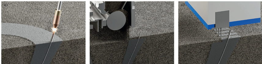
Abb. 6. Kombination eines additiven Metallschutzgasschweißprozesses zur Bewehrungsfertigung und der selektiven Leimintrusion als Beton-3D-Druckverfahren (aus [23]).
