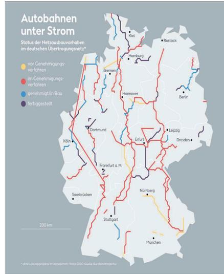
Abb. 6. Geplante und im Bau befindliche Hochspannungsleichstromkabel.<sup>9</sup>
