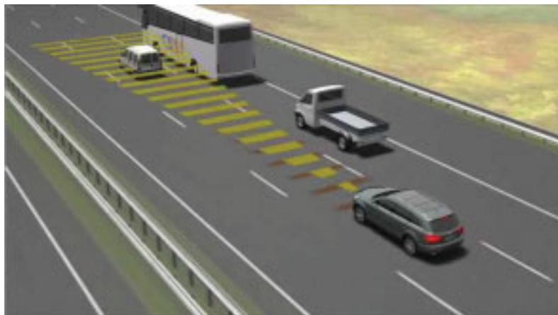
Bild 2.2: Anwendungsgebiet ACC (Quelle: Audi AG [2])
