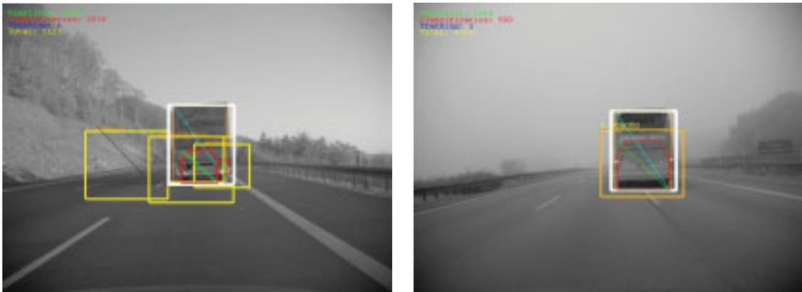
Bild 6.18: Fehlklassifikationen innerhalb von Heckansichten
