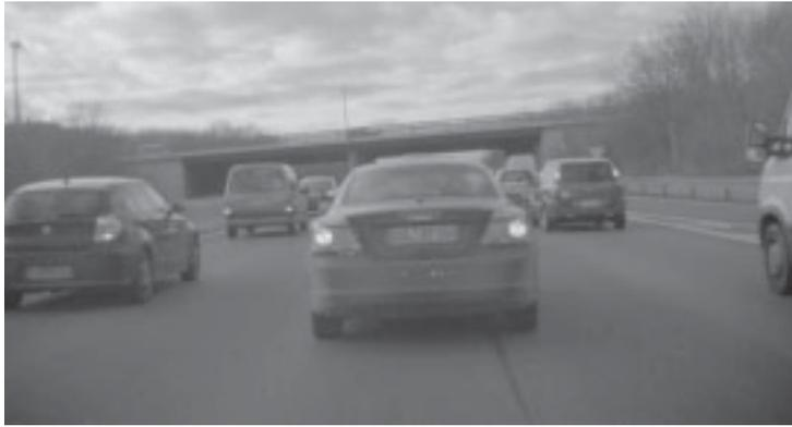
Bild 7.9: Verdeckung der Fahrspurmarkierung
