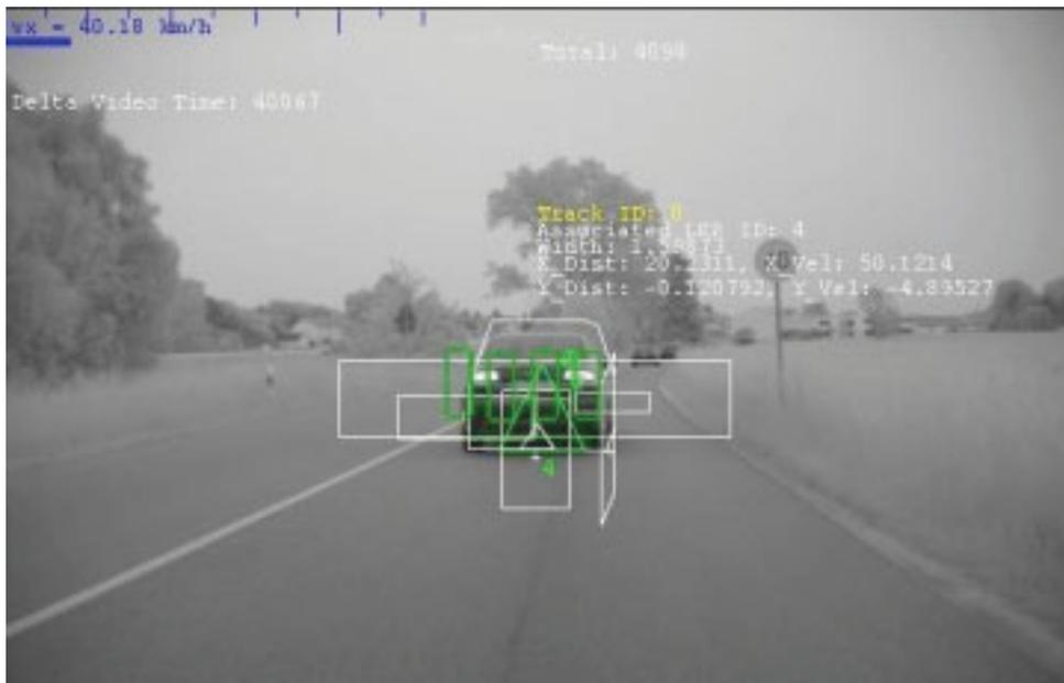
Bild 7.15: Multisensorielles Tracken des Fahrzeugs
