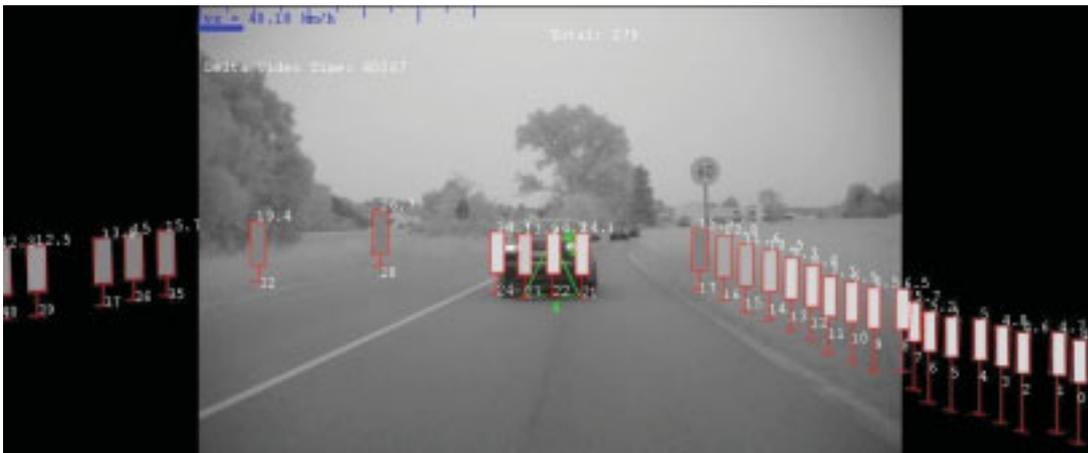
Bild 7.13: Sensorrohdaten ins Bild projiziert
