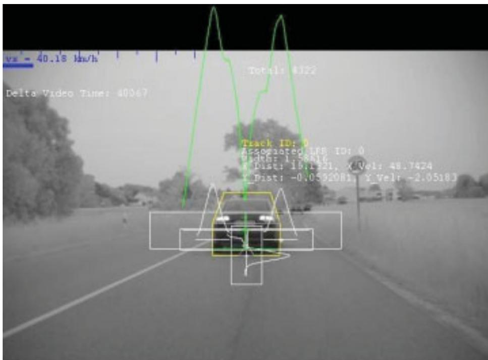
Bild 7.16: Operatorverläufe der Bildverarbeitung des Fahrzeugtrackers
