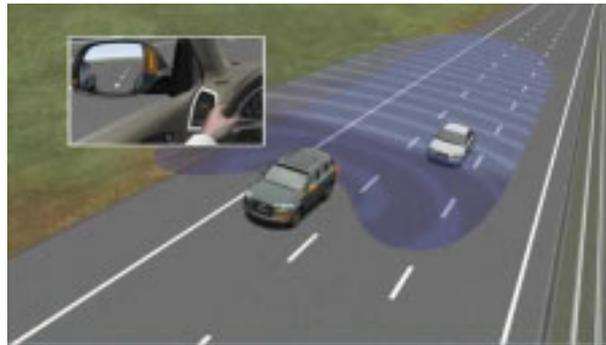
Bild 2.5: Spurwechselassistent (Quelle: Audi AG [2])
