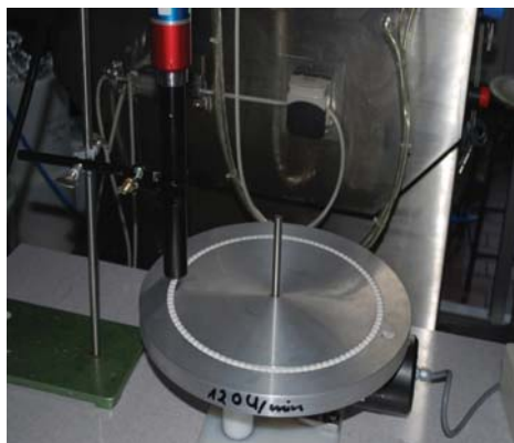
Abbildung 6-9: Versuchsaufbau für die Untersuchung der Coating Uniformity (vgl. Kapitel 3.6.2)
