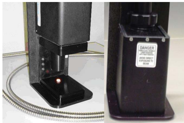
Abbildung 6-2: Probenhalterung für die offline Messungen mit geöffneter (links) und geschlossener (rechts) Haube.
