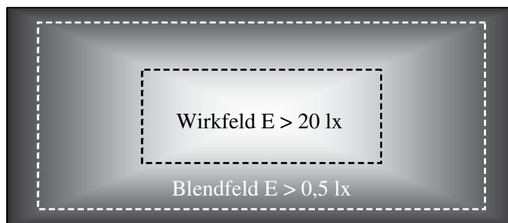
Abbildung 26 Wirk- und Blendfeld eines Lichtsegmentes
