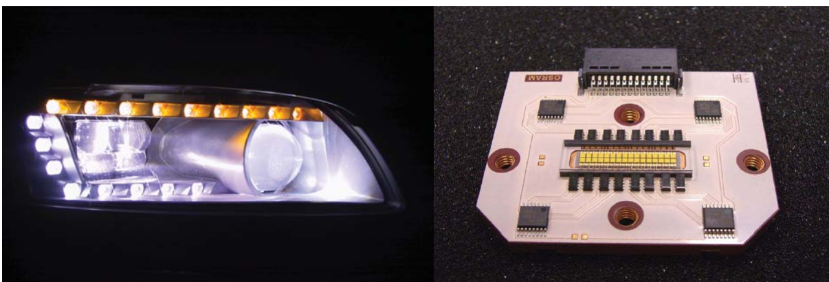
Abbildung 20 Nanolux-Scheinwerfer und das integrierte Osram Multichip-LED-Array für die Matrix-Beam-Funktion
