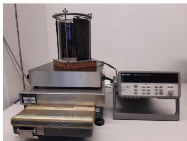
Abbildung 8: Schematische Darstellung des Versuchsaufbaus zur Untersuchung des Einflusses des Tensids SAS auf die Blasenentstehung und Wärmeübertragung während des Blasensiedens (links) und Fotografie des Versuchsaufbaus (rechts)
