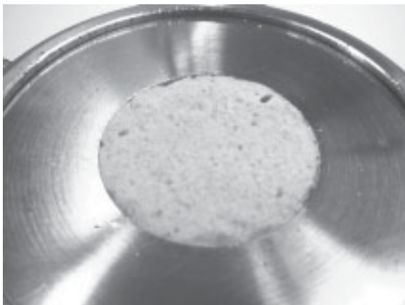
Bild E.10: Polyurethan-Proben im Hohlleiter-Aufbau. Links: Aufgeschäumtes Material. Rechts: Kugeln nach Anwendung des Spritzgussverfahrens.
