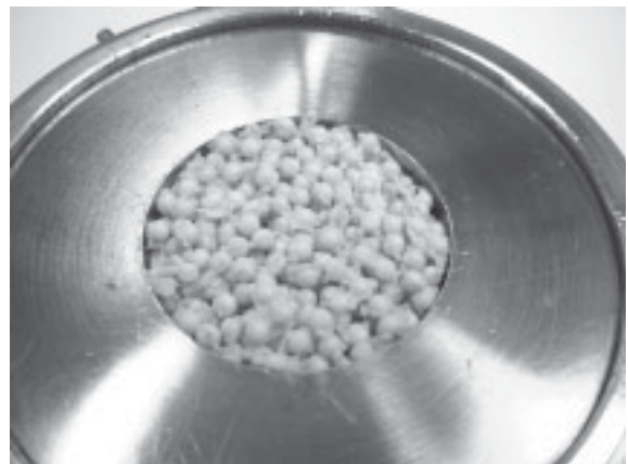
Bild E.10: Polyurethan-Proben im Hohlleiter-Aufbau. Links: Aufgeschäumtes Material. Rechts: Kugeln nach Anwendung des Spritzgussverfahrens.
