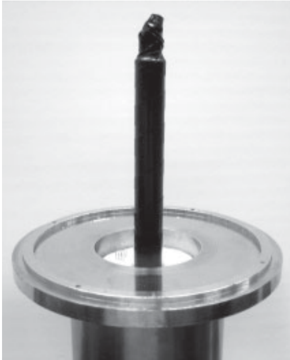
Bild E.9: Anordnung zur Vermessung der Resonanzen einzelner Partikel. Zum Schutz des angeschlossenen vektoriellen Netzwerkanalysators vor elektrostatischer Entladung ist der Innenleiter der offenen koaxialen Leitung elektrisch isoliert.
