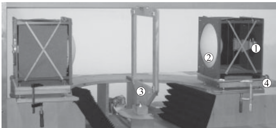
Bild 7.1: Freiraummessplatz in Transmissionsstellung. Bezeichnungen: 1) Breitband-Hornantenne, 2) dielektrische Linse, 3) Probenhalter, 4) feinmechanisches Verschiebesystem.
