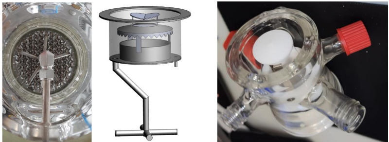
Abbildung 9.31: Flüssigkeitsverteiler in der DN150 Anlage (links) und Flüssigkeitssammler und Wiederverteiler (mitte) und Flüssigkeitssammler DN50 Kolonne (rechts)
