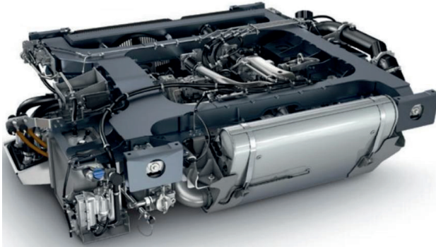
Abbildung 2: Powerpack mit Dieselmotor [5]
