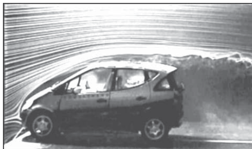
Abbildung 3.1: Formoptimierung einer Automobilkarosse im Windkanal
