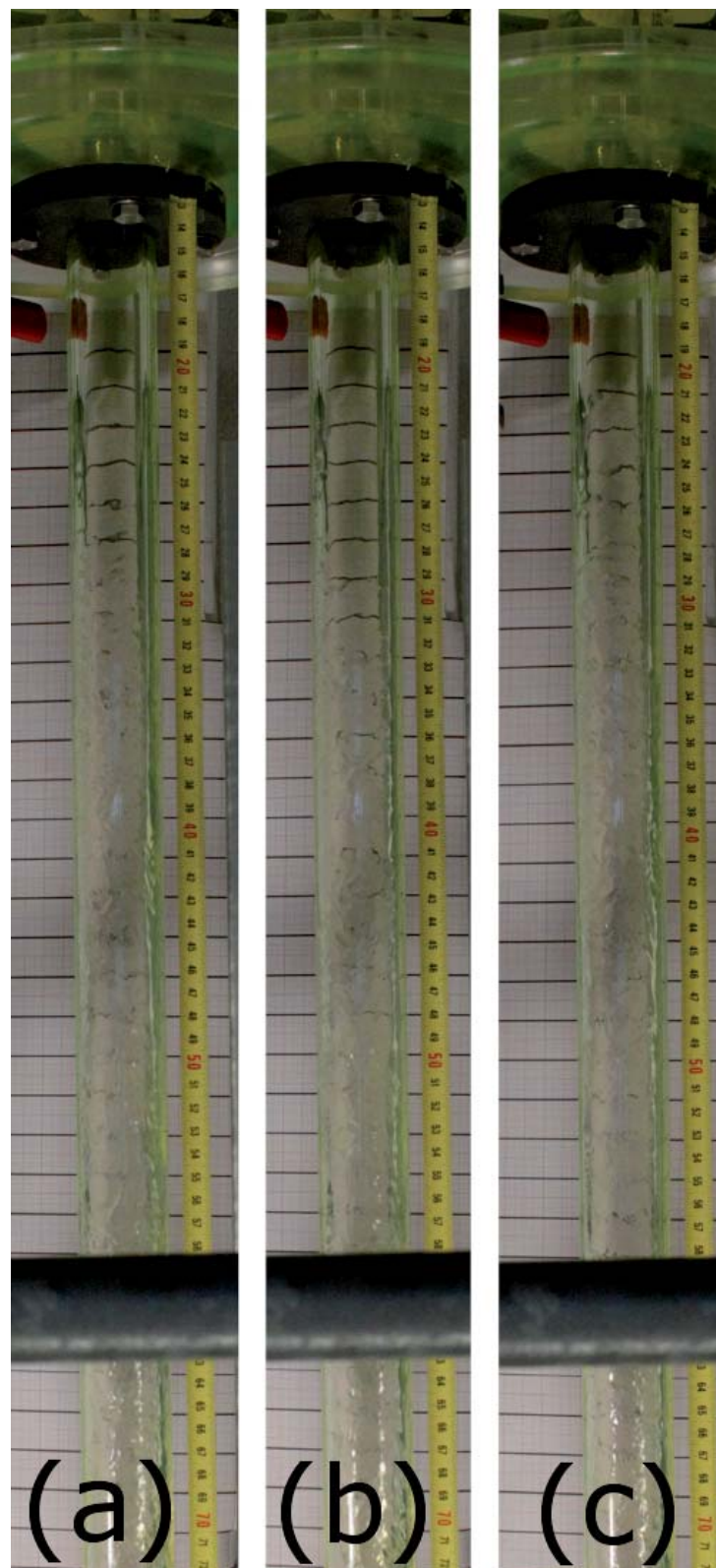
Abbildung 5.21: Filmstruktur eines Wasserfilms bei einer Berieselungsdichte von \dot{\Gamma} = 0,52 \frac{kg}{ms} und der Filmaufgabe durch das Glattwehr
