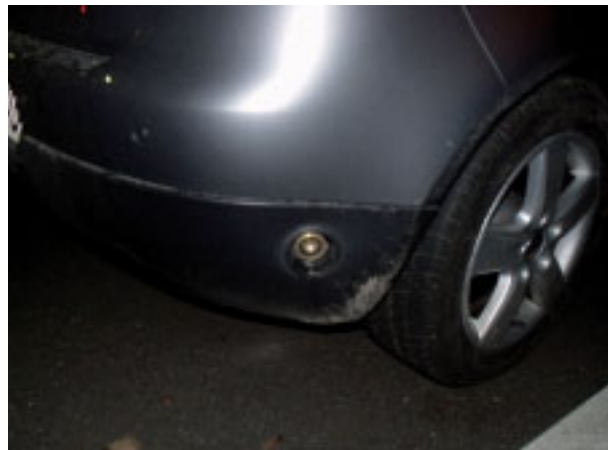
Unterschiedliche Möglichkeiten zur Positionierung des Gaseinfüllstutzens beim Ford Cougar, Kia Sportage, Honda CRV und VW Golf V (v.l.o.n.r.u.)
