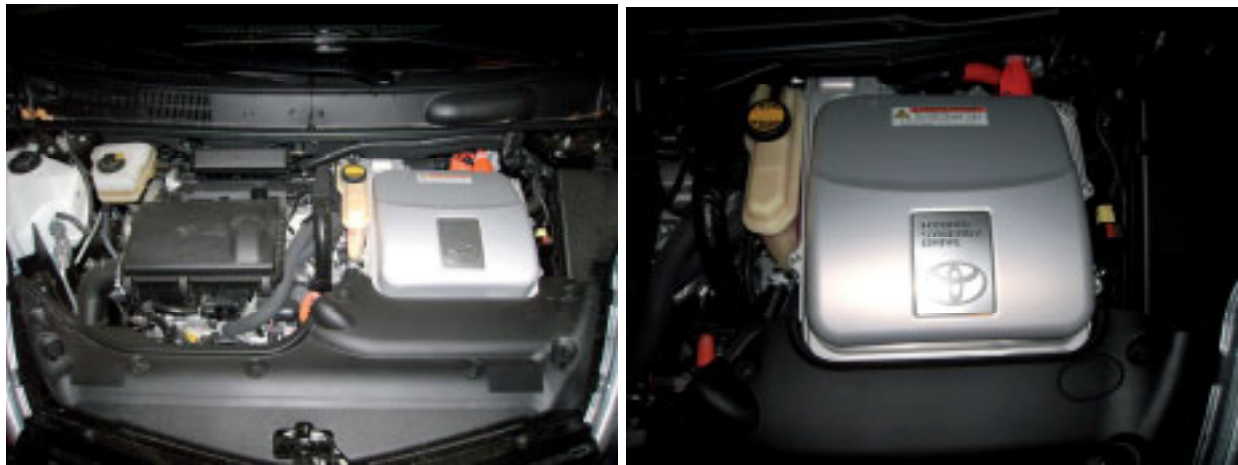
Der Systemmotor des Toyota Prius, bestehend aus Benzin- und Elektromotor
