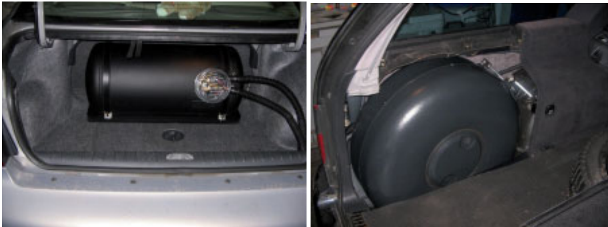
Der Einbau des Gastanks kann je nach Automodell an unterschiedlichen Stellen im Pkw erfolgen
