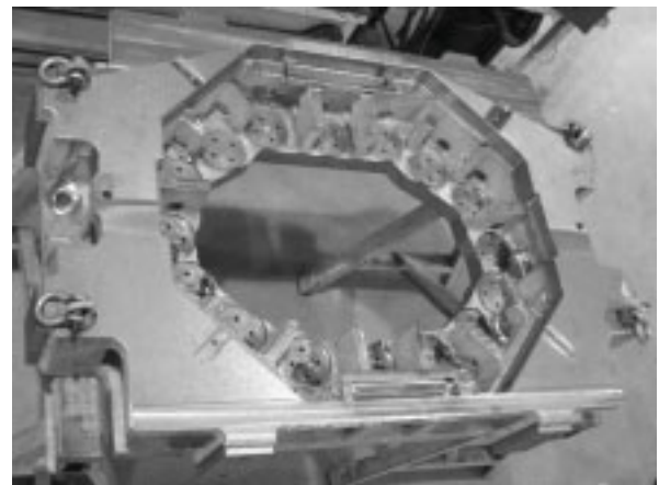
Abb. 4-54 Gussgrundkörper nach Bearbeitung der Normgeometrie
