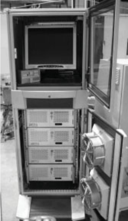
Abb. 4-9 Messschrank mit vier Bildverarbeitungsrechnern
