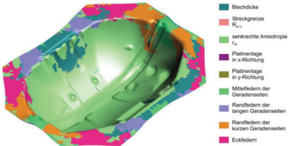
Abb. 5-30 Ergebnis der Sensitivitätsanalyse in AutoForm® mit Erläuterung und Benennung der Einflussfaktoren
