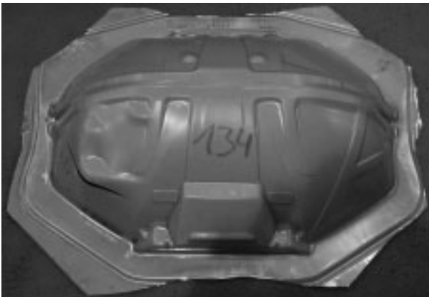
Abb. 6-5 Bauteil mit großem Riss
