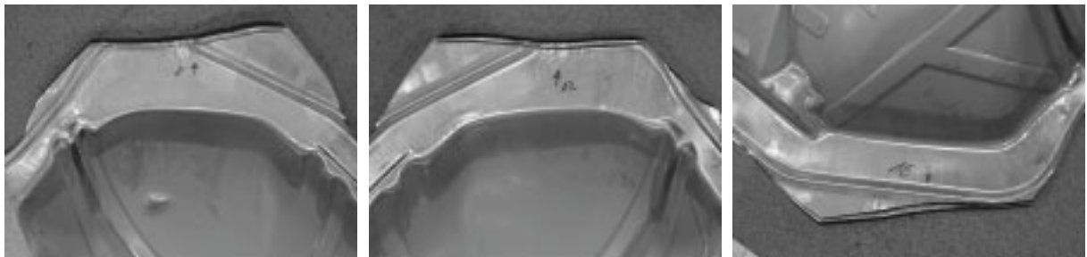
Abb. 5-16 unterschiedlich lange Flanschränder aufgrund von Druckunterschieden in den Eckfedern (Nr.: 8, 12, 16)
