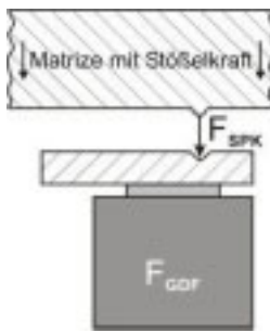
Abb. 4-35 Schnitt: elastischer Einsatz, außermittige Sickenprägekraft
