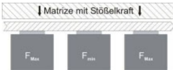
Abb. 4-33 Biegebalkenmodell: Darstellung definiert elastischer Einsatz auf 3 Zylindern
