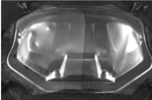
Abb. 5-28 tailored blank Bauteil ohne Falten, kurz vor UT
