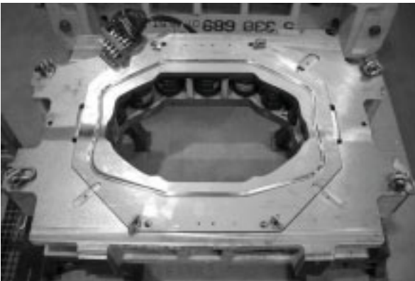
Abb. 4-57 elastischer Einsatz im Grundgestell
