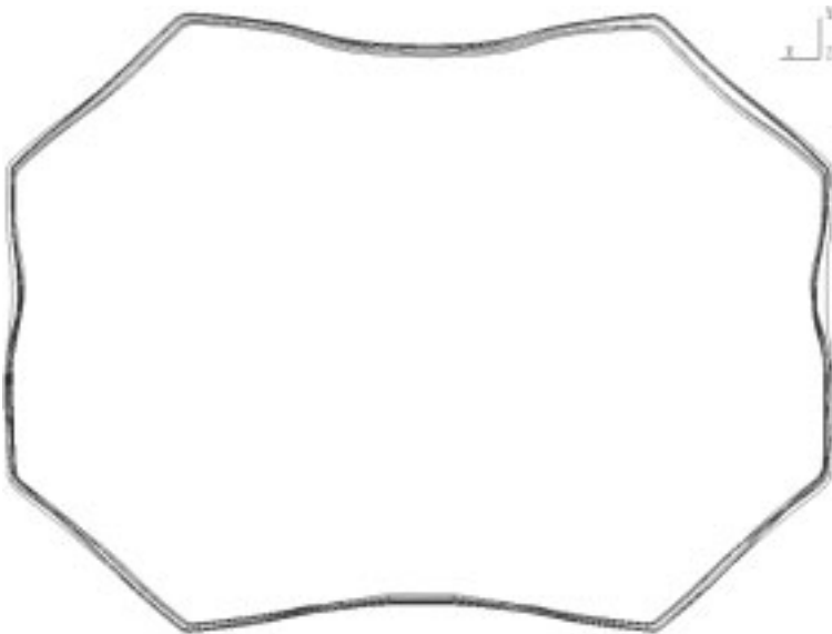
Abb. 4-19 simulierte Endlage der Platinenkante nach der Umformung für verschiedene Kraftkonfigurationen
