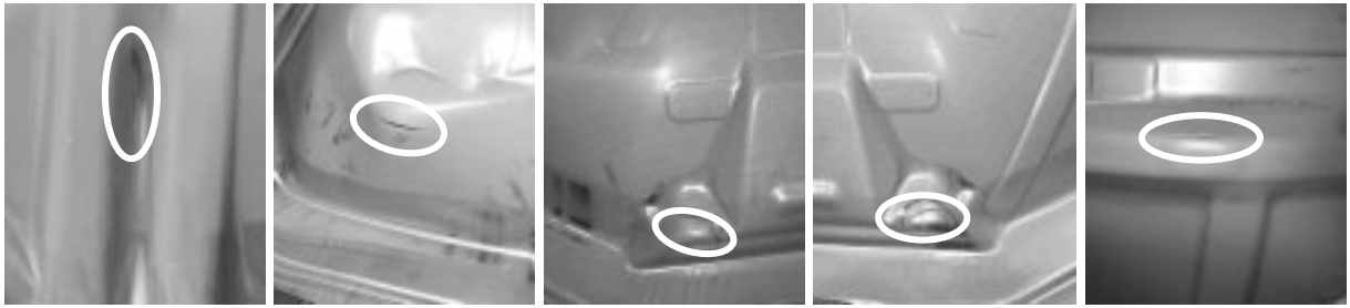
Abb. 6-6 Versuchsteile mit Einschnürungen, Dünnzügen und kleinen Rissen zwischen zwei Sensorpositionen
