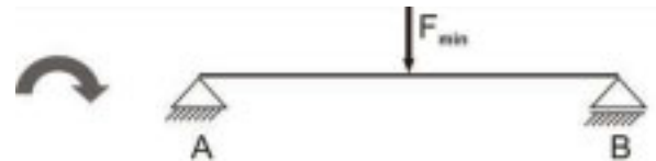
Abb. 4-34 Biegebalkenmodell: Darstellung als Stabdiagramm
