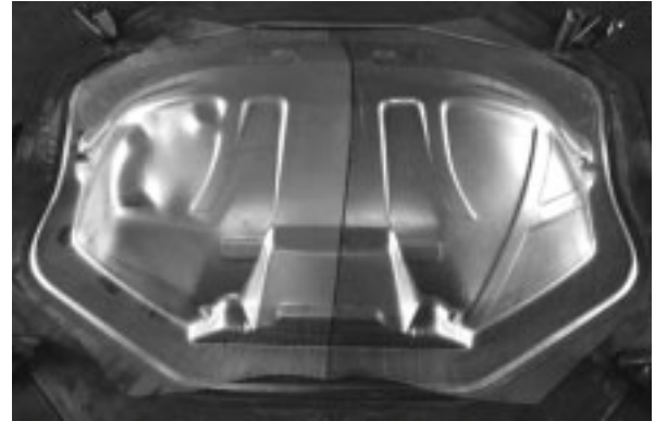
Abb. 5-29 faltens- und rissfreies tailored blank Bauteil, vollständig ausgeprägt
