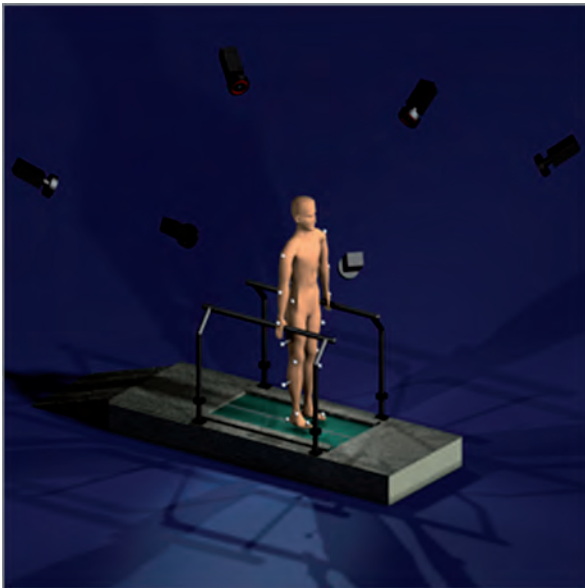
Abb. 4.1: Stereo-Kamera-System zur Detektion der räumlichen Markerpositionen
