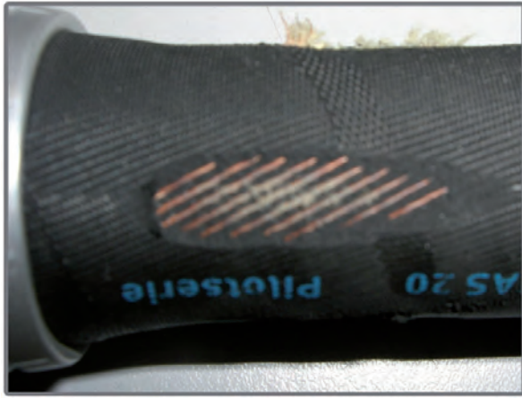
Abb. 3.13: Aramidfasern am DMSP-20 Muskel im unbelüfteten Zustand
