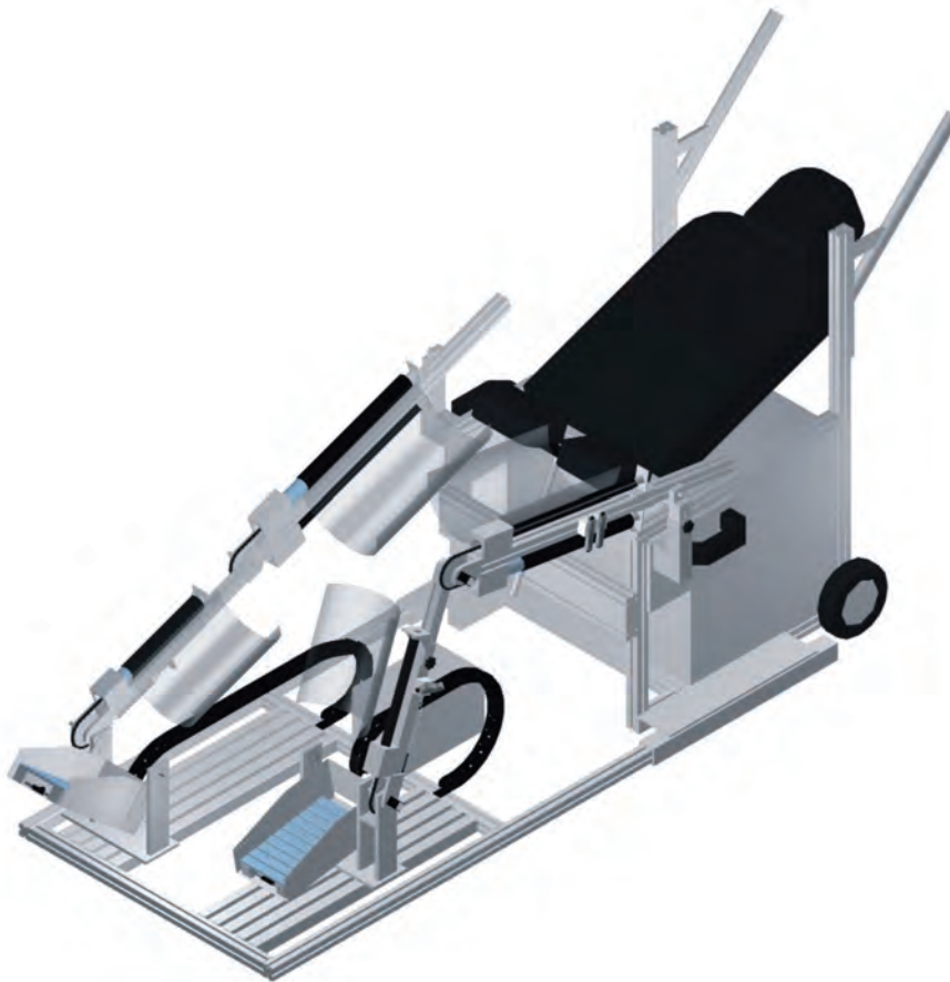
Abb. 1.6: Dreidimensionale CAD-Zeichnung des Gangtrainers
