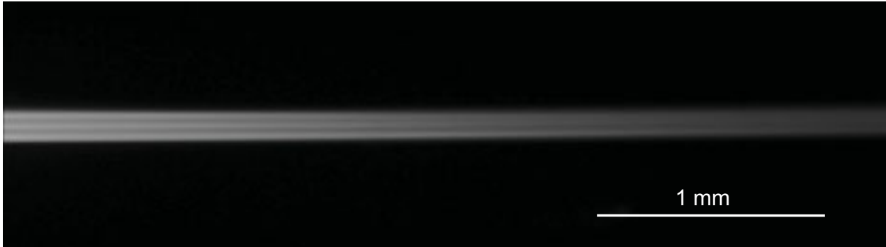
Bild 5.16: Foto der Intensitätsabnahme (grüne Fluoreszenz) entlang der Ausbreitungsrichtung in einem Filmwellenleiter. Es sind keinerlei Streuzentren zu sehen.
