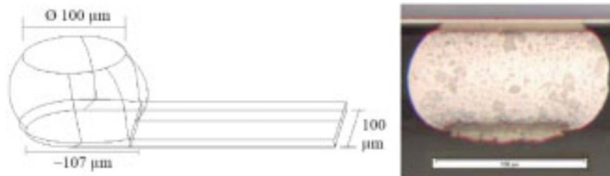
Abb. 3.11: Skizze eines Lotballs mit Abmessungen (links), Schlichtbild im Ausgangszustand (rechts), (Spraul et al., 2007)
