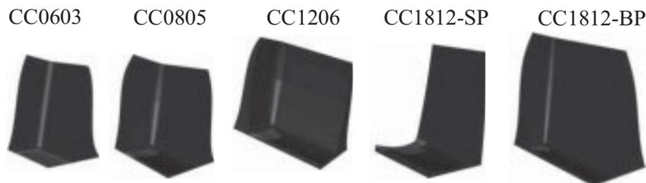
Abb. 4.75: Ausgewertete Lotbereiche der verschiedenen Bausteine, konstantes Volumen (KV)
