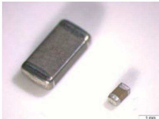
Abb. 1.1: Keramische Kondensatoren (Scheel et al., 2008)
