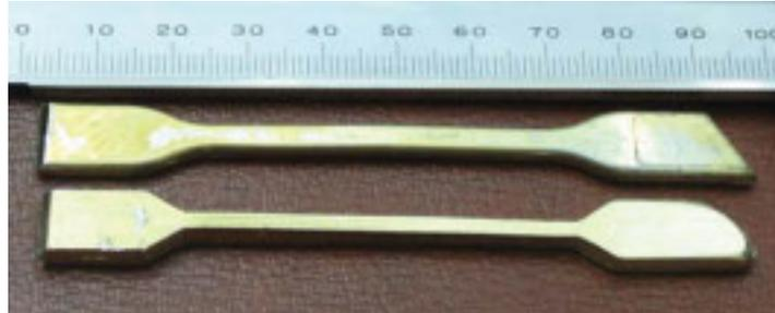
Abb. 1.9: Doppelschulterzugproben (Wiese et al., 2007)
