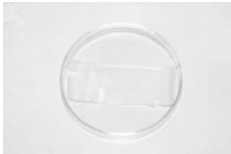
Abbildung 7.1-1: Dargestellt ist der mittels Roll-Casting hergestellte Polymerfilm SBS_KAI.
