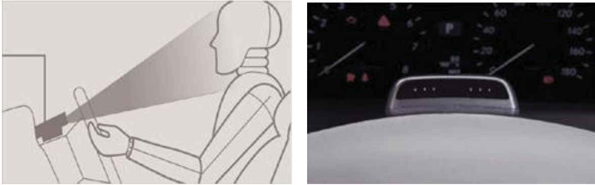
Abbildung 3.8: Anordnung der Fahrerbeobachtungskamera beim Lexus Pre-Crash Safety System (The Auto Channel, 2006)
