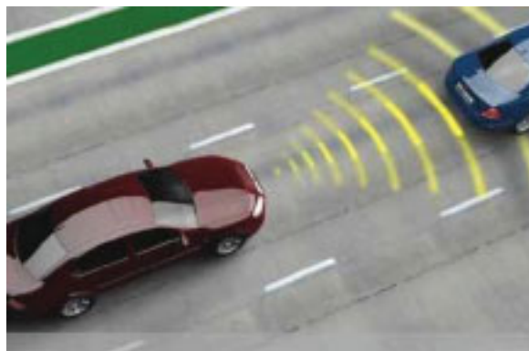
Abbildung 3.1: Das ACC-System, der Abstandsregeltempomat (KfzTech, 2008)
