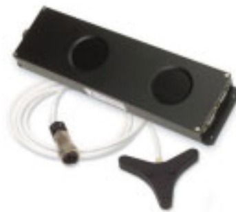
Abbildung 3.15: Referenzsensor – Lasertracker LaserBIRD bestehend aus einer Haupteinheit (oben) und einem Sensor mit 3 Photodioden (unten rechts), (Ascension Technology Corporation , 2007)
