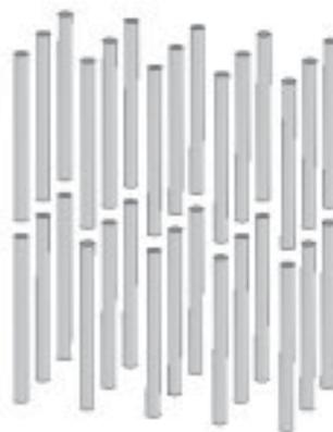
Abbildung 3.2.2: Geometrischer Aufbau der „Cut-Wire“ Struktur
