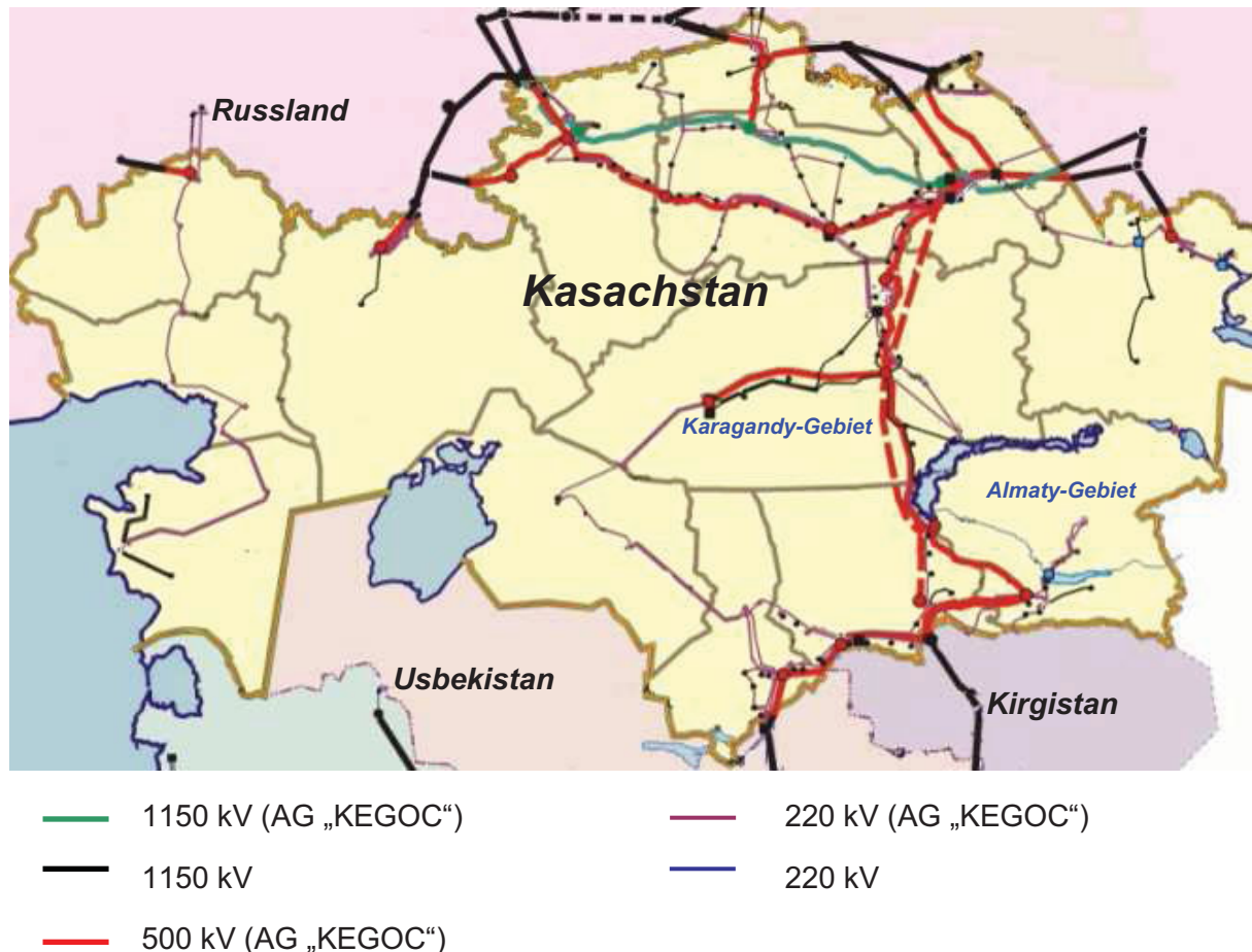
Abbildung 9: Energieversorgungsnetz in Kasachstan 37
