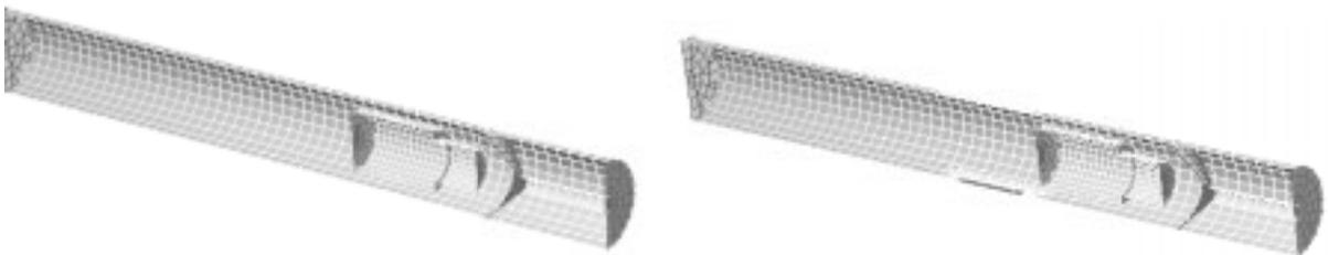
Bild 4.4: Simulationsmodelle des Testsystems ohne und mit Seitenschlitzen unter Berücksichtigung des metallischen Batteriegehäuses im Inneren des Testsystems
