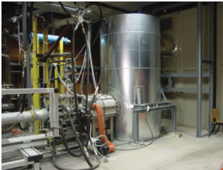
Abbildung 3.3.10 Aufbau für Heißversuche
