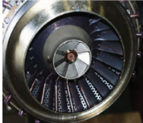
Brenner der Fa. Siemens
