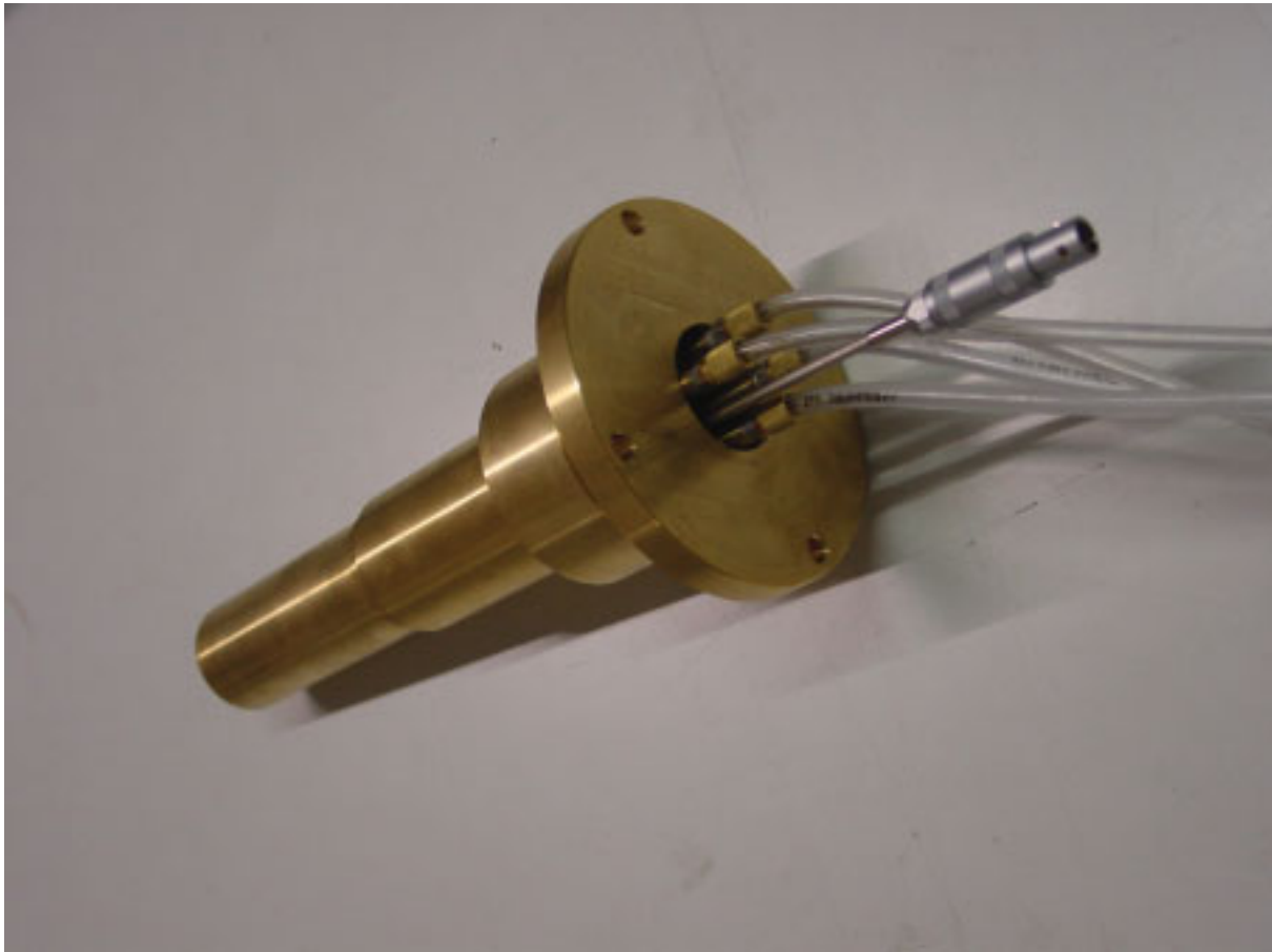
Abbildung 4.3.1 Wassergekühlter Adapter für Druckaufnehmer
