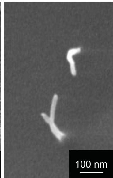
Abb. 21: Pullout von MWCNT an einer Matrixbruchfläche.
