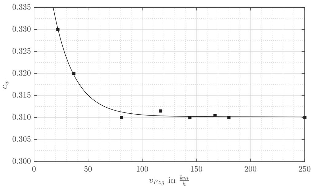
**Abbildung 2.2:** Exemplarischer Verlauf des Luftwiderstandsbeiwertes über Geschwindigkeit [44]
