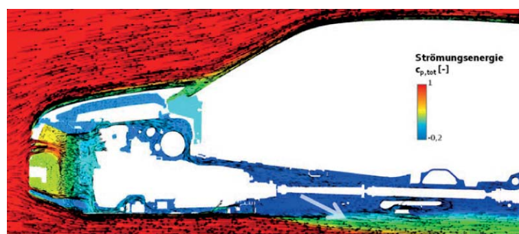
Abbildung 2.4: Strömungsenergie der Kühlluft [44]
