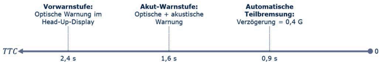
Abbildung 1.7: Warnkaskade des exemplarisch zu bewertenden Fahrerassistenzsystems ( TTC = \text{Time to collision} )
