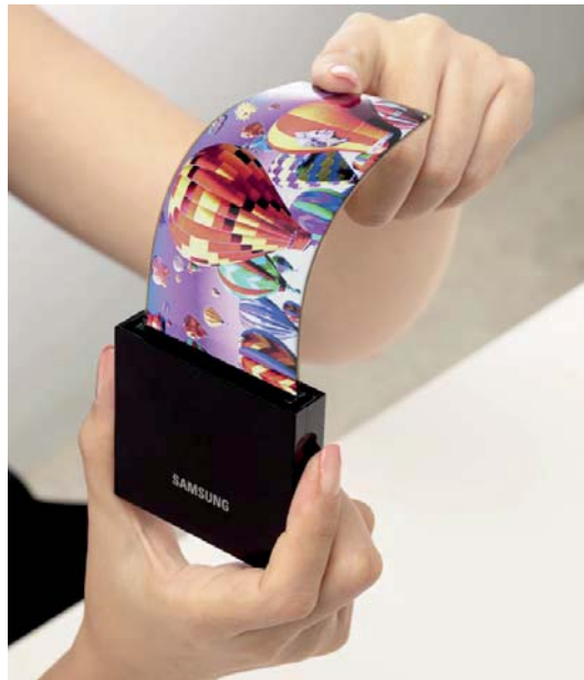
Abbildung 1.2: Ein biegbares 5,7 Zoll AMOLED-Display der Firma Samsung . Erstmals wurde hier eine Polymerfolie als Substratträger eingesetzt, was die Biegsamkeit, Elastizität und Bruchresistenz erhöht. Aus [9]
