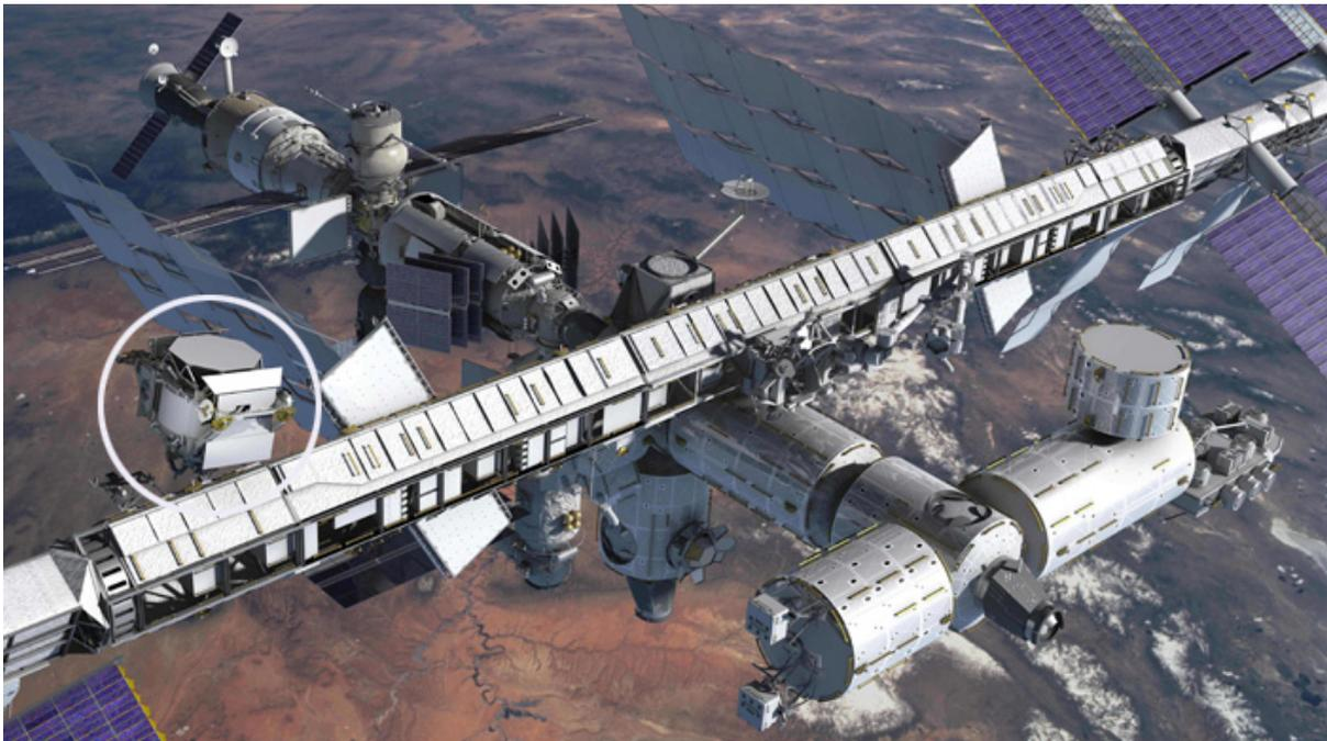
*Der weiße Kreis auf dem Foto der Weltraumstation kennzeichnet den Alpha-Magnet-Spektrometer*
