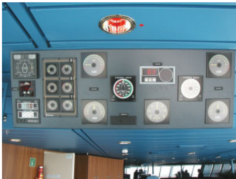
Abbildung 2.2: Tochteranzeige über dem Seitenfahrstand eines Kreuzfahrtschiffs. In den Anzeigen werden die wichtigsten Größen wie Schiffskurs, Maschinenleistung und Ruderstellung schnell erkennbar dargestellt. Viele der Anzeigeelemente sind dabei ebenfalls im zur Tochteranzeige zugehörigen Seitenfahrstand vorhanden.
