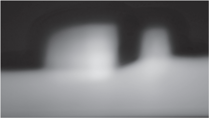
Abbildung 2: Lichtverteilung eines Matrix LED-Scheinwerfers mit Abblendlicht und einer Lücke im Fernlicht
