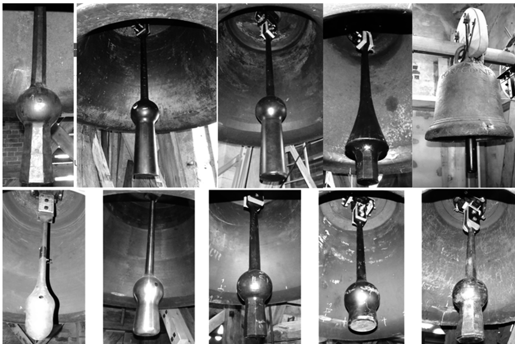
Abb. 11: Vom ECC-ProBell® konstruierte Klöppel
