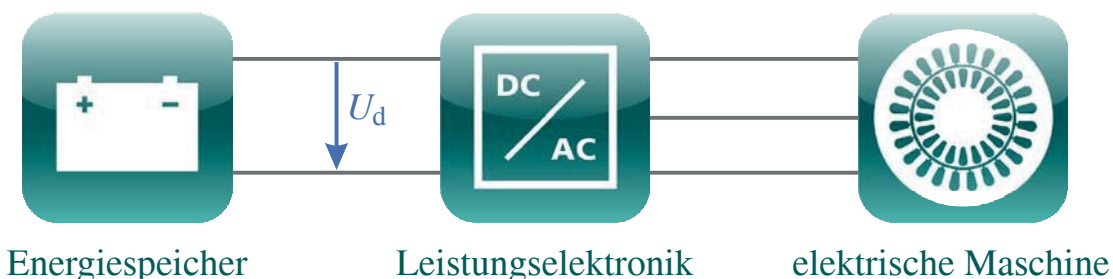
Abbildung 1.1: Prinzipdarstellung des elektrischen Antriebsstrangs in einem Kraftfahrzeug
