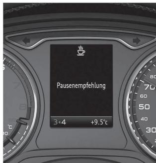
**Abbildung 4:** Beispiel einer visuellen Müdigkeitswarnung im Kombiinstrument eines Fahrzeugs (Bildquelle: AUDI AG)
