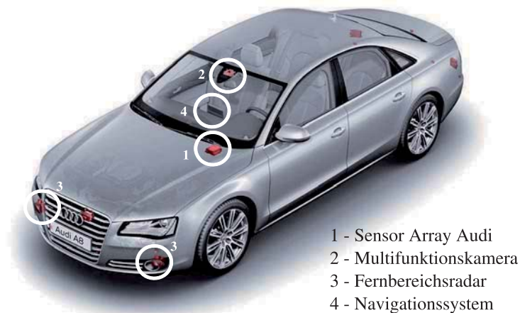
Abbildung 1.6.: Verbauorte der verwendeten Sensoren
