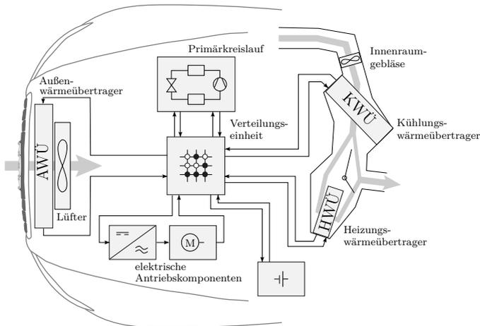
**Abbildung 1.2:** Grundlegender schematischer Aufbau des in dieser Arbeit untersuchten Sekundärkreislaufsystems mit einem kältemittelführenden Primärkreislauf. Die Verteilereinheit ermöglicht die Darstellung verschiedener vom jeweiligen Betriebsfall abhängiger Verschaltungszustände auf der Sekundärfluideite.
