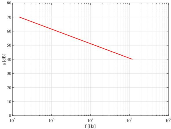
Abbildung 1.3.: 70/40 dB-Dämpfungskurve für Schirmungsanforderung im HV-System
