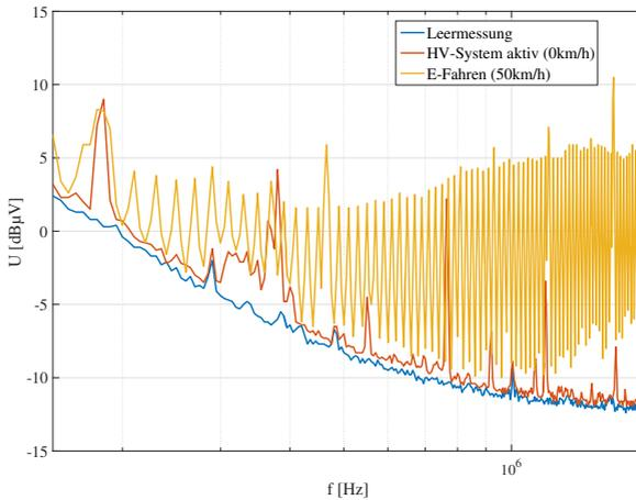
Abbildung 1.6.: AM-Messung am Forschungsdemontator eBuggy für verschiedene Betriebszustände
