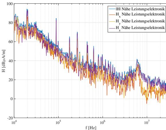
Abbildung 1.7.: Magnetfeldmessung am Forschungsdemontator eBuggy im Fahrbetrieb
