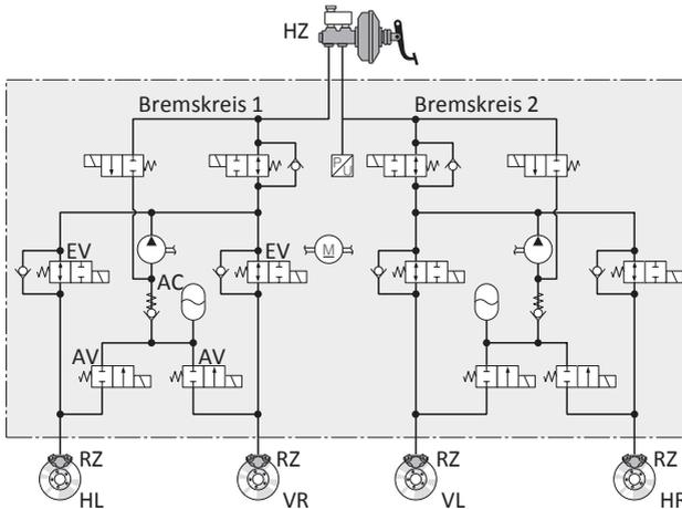
Abbildung 1-5: Hydraulikschaltplan des Bosch ESP 8 nach [Rei10, S. 144]
