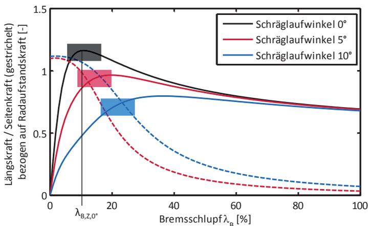
Abbildung 1-3: Reifenkennlinien und ABS-Regelbereiche<sup>6</sup>
