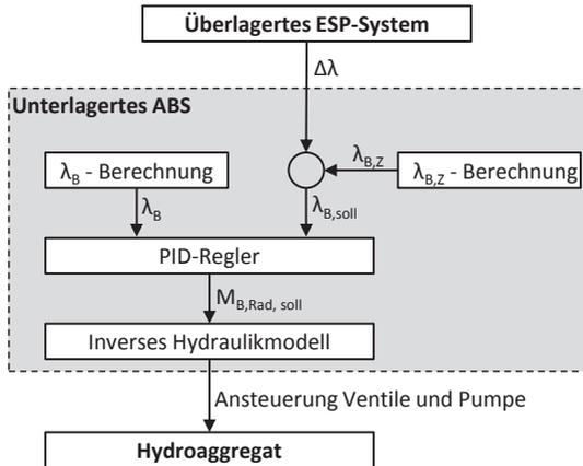
Abbildung 1-4: Kontinuierlicher Bremschlupfregler nach [ZELP98, Ise06]
