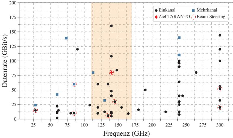
Abbildung 1.4.: Stand der Technik erzielter Datenraten von voll-elektrischen, drahtlosen Kommunikationssystemen [14–86].
