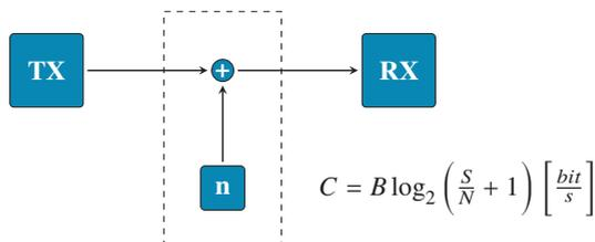
Abbildung 1.1.: Abstraktion einer (drahtlosen) Kommunikationsstrecke über einen AWGN-Kanal.
